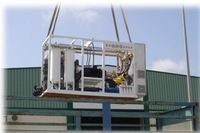
Transporte de un equipo desalador de agua de mar modelo PM-525; Producción de 525 m 3 /día.
