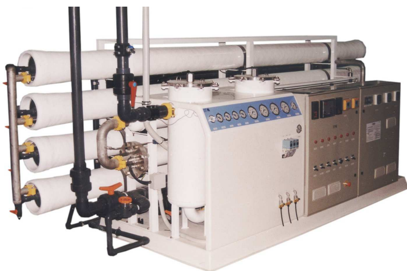
Equipo desalador de agua de mar modelo PM; Producción de 250 m 3 /día
