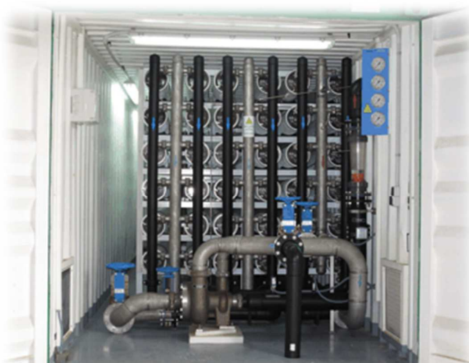
MA 5000 - CONTENEDOR CON MEMBRANAS Y RECUPERADOR DE ENERGIA
